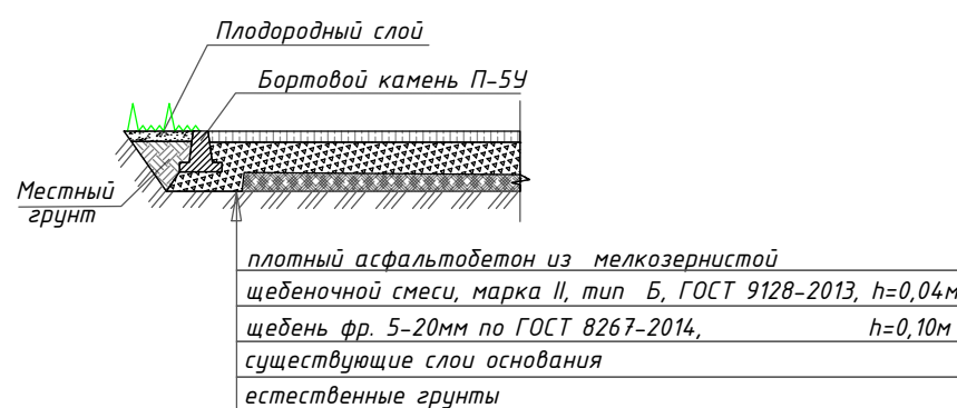
КОНСТРУКЦИЯ ДОРОЖНОЙ ОДЕЖДЫ ПРОЕЗДОВ ВДОЛЬ ДОМА И ВЪЕЗДОВ В КВАРТАЛЫ
